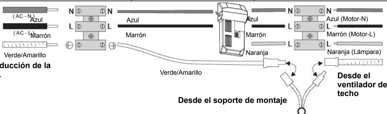
**4.** Conexión de la regleta: Afloje primero los tornillos de la regleta, de tal manera que los cables puedan encajar. Siga las instrucciones como en el gráfico. Asegúrese de que las puntas de los cables se encuentran completamente dentro de la regleta y están atornillados.
