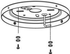
**1.** Pase los cables de suministro a través del agujero del soporte de montaje. Asegure el soporte de montaje a una viga del techo u otro elemento estructural con dos tornillos, arandelas de resorte y arandelas planas. Asegúrese de que el soporte de montaje puede sostener con seguridad el peso en movimiento del ventilador.
