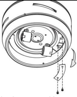
7. Retire la protección metálica curva de la caja de la lámpara retirando los dos tornillos.
