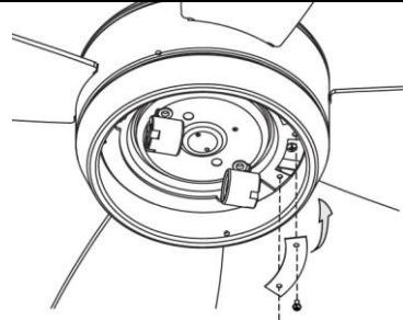
9. Atornille de nuevo la protección metálica curva en la caja de la lámpara con los dos tornillos.
