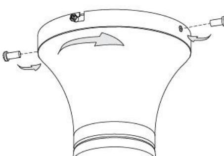
**6-1.** Deslice el embellecedor hasta el techo y gírelo de tal manera hasta que los dos tornillos del soporte de montaje entren en los huecos con forma de L del embellecedor.
