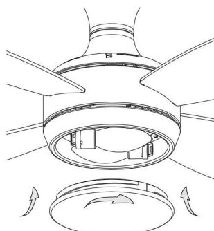
**11.** Setzen Sie den Leuchtschirm auf das Leuchtengehäuse und drehen Sie den Schirm vorsichtig im Uhrzeigersinn bis er fest sitzt.
