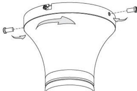
**6-1.** Heben Sie die Abdeckung so an, dass die beiden Schrauben am Montagebügel in den L-förmigen Schlitz der Abdeckung einrasten.
