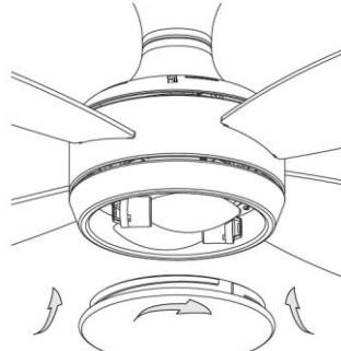
11. Coloque la pantalla de cristal a la caja de la lámpara y gire cuidadosamente la pantalla en el sentido de las agujas del reloj hasta quedar fija.
