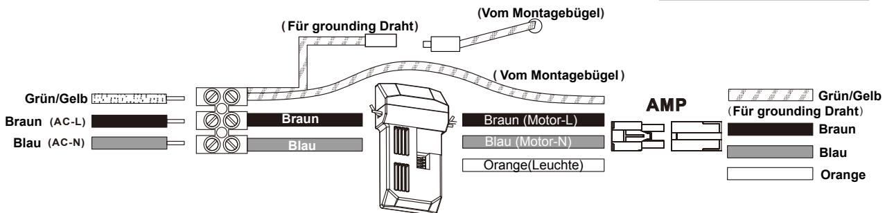
**4.** Lüsterklemmenverbindung: Lösen Sie zunächst die Schrauben an den Lüsterklemmen, so dass die Kabel aufgenommen werden können. Folgen Sie dann obiger Abbildung. Stellen Sie sicher, dass die Kabelenden vollständig innerhalb der Lüsterklemme liegen und fest verschraubt sind.
