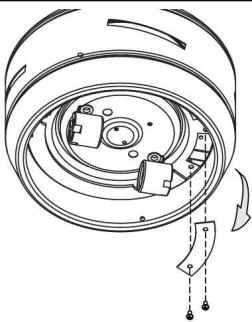
**7.** Entfernen Sie die gekrümmte Metallabdeckung im Leuchtengehäuse indem Sie die beiden Schrauben entfernen.
