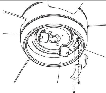
**9.** Verschrauben Sie die gekrümmte Metallabdeckung wieder im Leuchtengehäuse mit den beiden Schrauben.
