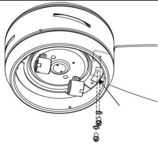
**8-1.** Führen sie ein Rotorblatt in die Aussparung im Motorgehäuse ein.
