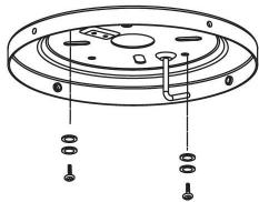
**1.** Führen Sie die Zuleitungskabel durch die Öffnung im Montagebügel. Befestigen Sie den Montagebügel an einem Deckenbalken oder anderen tragenden Element der Decke mit zwei Schrauben, Federringen und Unterlegscheiben. Stellen Sie sicher, dass die tragende Struktur an der der Montagebügel befestigt wird die dynamische Last des Deckenventilators sicher trägt.
