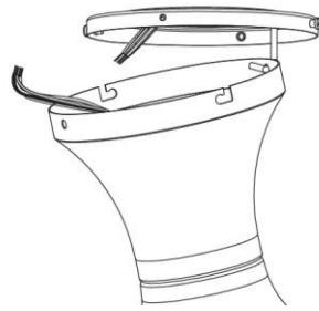
**2.** Levante la caja de montaje y cuelguela en el gancho del soporte de montaje. Esto le permitirá hacer las conexiones eléctricas necesarias sin necesidad de tener que sostener el ventilador a la vez.
