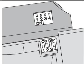
El mando a distancia y el receptor tienen un interruptor de frecuencia cada uno. Los llamados interruptores DIP, tienen 4 palancas pequeñas numeradas, que por fábrica se encuentran en "ON". Posicione estas palancas con ayuda de un pequeño destornillador o bolígrafo en una de las combinaciones posibles. Asegúrese de posicionar la misma combinación en el mando a distancia y el receptor. Tenga en cuenta de que la dirección de la posición "On" de estos puede ser diferente.
