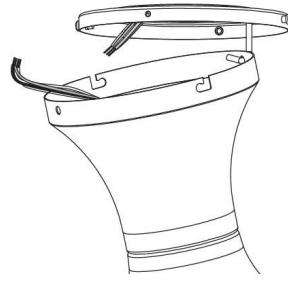
**2.** Heben Sie den Deckenventilator an und hängen Sie ihn an den Haken des Montagebügels. Nun können Sie die Kabelverbindungen herstellen, ohne das Gerät halten zu müssen.
